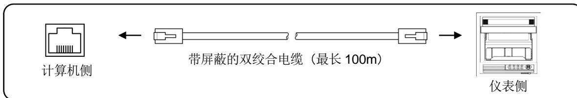
● 计算机和 HUB、Ethernet 仪表间的接续例（1 对 N 接续）
